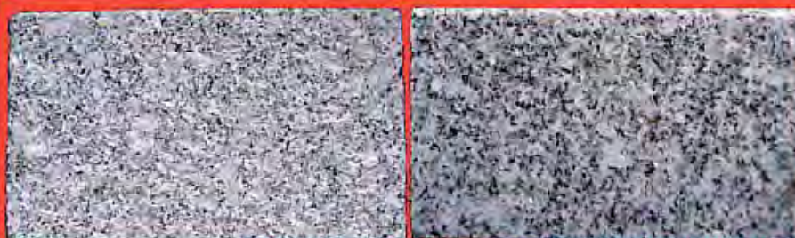
Campione di granito Luz de Compostella™, fiammato (a sinistra) e lucido (a destra). Samples of Luz de Compostella™ granite, flamed (left) and polished (right).
